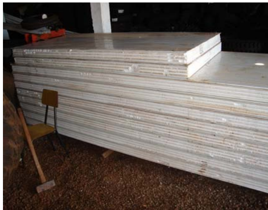
Foto 11: Paredes da câmara fria
